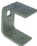
Justierelement zum Einstellen der Fertigdeckenhöhe. Dieses Bauteil wird ab einer Abhängöhe von mindestens 220,0 mm zwischen der Rohdecke und der Unterkante des Schwerlastprofils (Höhe 80,0 mm) verwendet. Bei dem 160,0 mm hohen Profil muss die Abhängöhe mindestens 300,0 mm betragen.
