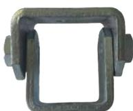
Gelenkbügel zur seitlichen Befestigung an einer Rippendecke, zur Montage der Abhängungen des Schwerlastdeckensystems. Durch Einstellen des Gelenks lässt sich der Abhänger senkrecht ausrichten.
