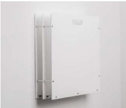
Eine Wandhalterung dient zur Aufbewahrung von Streustrahlenrasterplatten. Sie besteht aus drei Acrylglasplatten, die durch Aluminiumrohre auf einen Abstand fixiert werden. Die Bodenrohre sind zusätzlich mit Kunststoffschläuchen ummantelt, um die Aufnahme der Streustrahlenrasterplatten abzdämpfen. Die Kanten und Ausschnitte der Acrylglasplatten werden gelasert.
