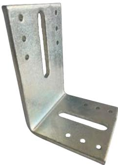
Winkel zur direkten Befestigung des Schwerlastprofils an der Rohdecke, Gewindeschraube M10 x 80 mm, Mutter und Befestigungsschraube 4,8 x 19 mm. Die Abhängehöhe ist die Höhe zwischen der Rohdecke und der Unterkante des Schwerlastprofils.
