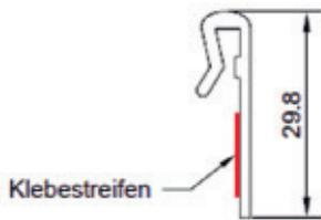
Mit dem Fugenclipprofil ist ein dichter Stoß zwischen zwei Metallkassetten sichergestellt. Die Fuge zwischen den Kassetten kann sich nicht öffnen.
