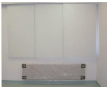
Die Bedienung der Flächenvorhänge kann manuell oder elektrisch erfolgen. Die Ausführung erfolgt als Sandwichelement, der Bleiwert kann bis zu Pb 3,0 mm Stärke betragen und die Lamellenlänge bis 3.000 mm. Sie sind leicht zu reinigen und zu desinfizieren.
