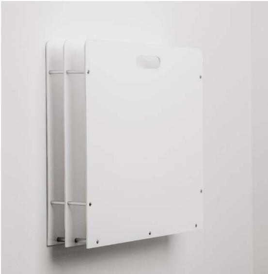
Eine Wandhalterung dient zur Aufbewahrung von Streustrahlenrasterplatten. Sie besteht aus drei Acrylglasplatten, die durch Aluminiumrohre auf einen gewünschten Abstand fixiert werden. Die Bodenrohre sind zusätzlich mit Kunststoffschläuchen ummantelt, um die Aufnahme der Streustrahlenrasterplatten abzdämpfen. Die Kanten und Ausschnitte der Acrylglasplatten werden gelasert.
