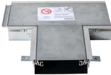
Formstücke als T- und Kreuzabzweige werden werkseitig vormontiert geliefert. Auf der Baustelle werden sie dann, ähnlich einem Baukastenprinzip, mit dem Standardkanal zusammengebaut.
