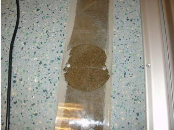
Der ausgeschnittene Boden ist hier bereits mit glasklarem Gießharz aufgefüllt.
