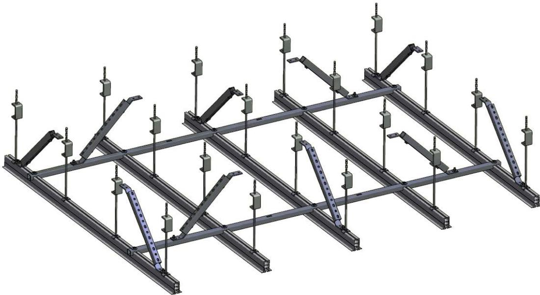
Schematische Darstellung der Schwerlastdeckenkonstruktion mit festem Raster 675 mm.
