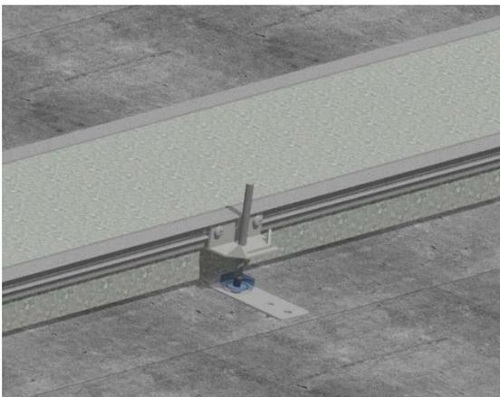
Beim Zusammenfügen der Kanaleinheiten ist darauf zu achten, dass die Stoßstellen sauber verarbeitet werden, damit keine Spalten entstehen. Die im Beipack befindlichen Befestigungswinkel mit Nivelliereinheiten M8 werden an das Seitenprofil der Kanaleinheiten angesetzt und grob auf die vorgegebene Estrichhöhe nivelliert.
