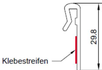
Die Deckenplatten können auch mit dem Fugenclipprofil jederzeit revisioniert und später wieder im ursprünglichen Zustand eingebaut werden. Das Profil wird im Farbton RAL 9010 geliefert, wie alle anderen Einbauteile dieses Systems auch.
